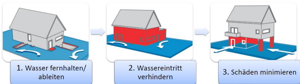
Abbildung 23: Hochwasser- / Starkregenangepasste Bauweise
